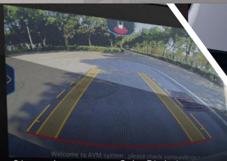
Cámara de reversa con Guías Dinámicas
