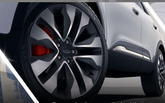
Frenos de disco ventilado delanteros y traseros sólido
